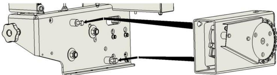
Теперь можно полностью затянуть два крепежных болта, а затем гайку на литой пластине. Установите передние и задние пластиковые колпачки, следя за тем, чтобы не зажать кабели в процессе установки колпачков.
