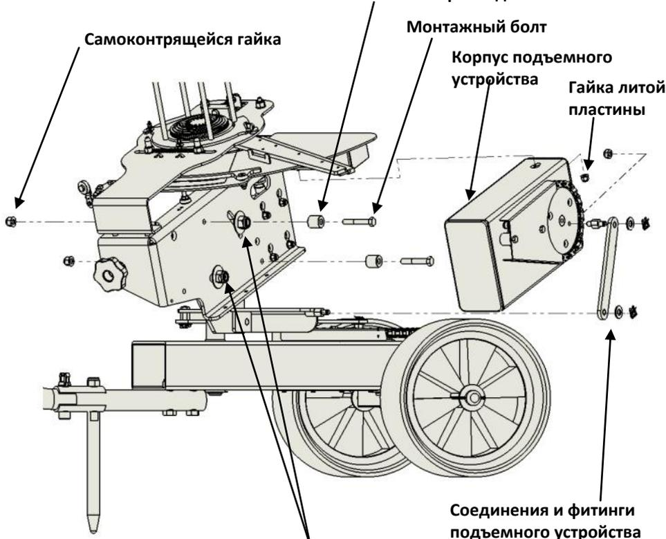
Установить крепежные болты в отверстия для крепежа, как показано выше, надеть самоконтращуюся гайку на каждый болт и вручную затянуть таким образом, чтобы головки болтов немного выступали.
